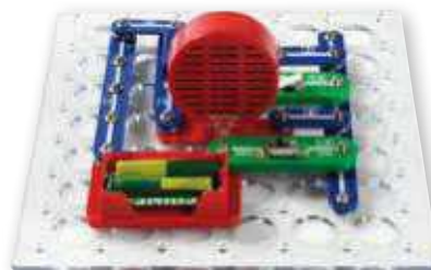
Experiment: Türklingel mit Druckschalter
