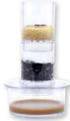
minimaler zweistufiger Filter mit Sand und Aktivkohle
